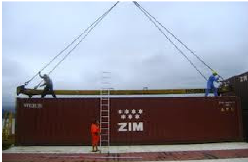
Figura 1 - Acoplamento do "spreader" ao container
